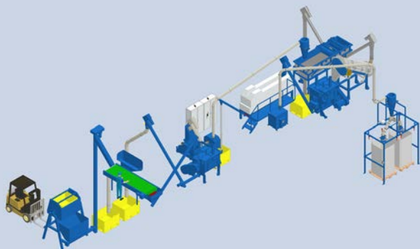
SEPARACIÓN DE MATERIA ORGÁNICA, PLÁSTICO Y METAL SEPARAÇÃO DE MATERIAL ORGÂNICO, PLÁSTICO E METAL
